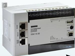
*Ядром системы является программируемый контроллер, который получает информацию с датчиков и передает ее в диспетчерский центр по каналам сотовой связи. Дискретные датчики (до 16 шт) подключаются непосредственно к контроллеру. Аналоговые датчики подключаются через модули расширения/ввода. Таким образом, система может быть легко масштабирована при необходимости.*
